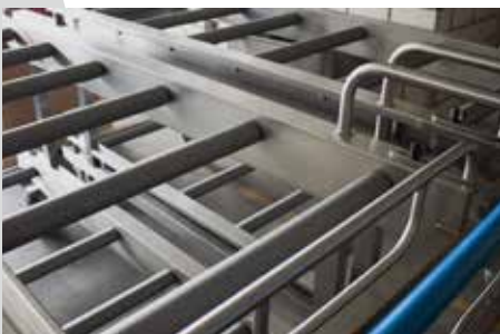
Führungsbahnen mit Rollen, Transportsicherung
